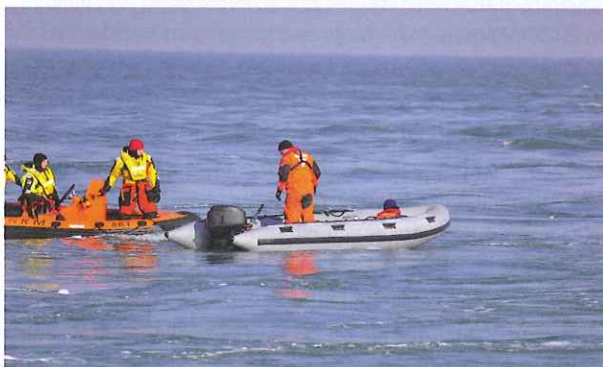
Van boven naar onder: voor de veiligheid wordt de proefneming achter het eigen schip uitgevoerd. Het piratenbootje nadert het schip en komt in de P-trap. Duidelijk is te zien hoe de bemanning naar voren wordt gelanceerd. De schroef is vastgelopen en het piratenbootje kan niet meer verder.
